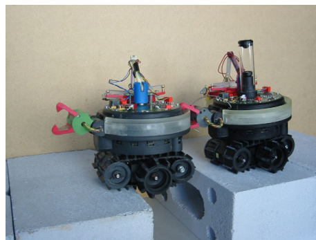
Abbildung 2. 2 s-bots beim Überqueren eines Grabens ( www.swarm-bots.org )
